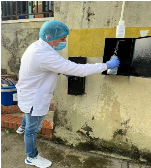
Toma de muestra de línea de red de Alvarado
